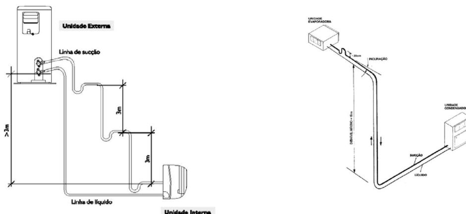
j) todas as dobras na tubulação de cobre deverão ser feitas com o auxílio de ferramenta adequada (mola de dobramento), para evitar estrangulamento dos tubos. Em hipótese alguma poderão ser feitas curvas nos tubos com as mãos;
