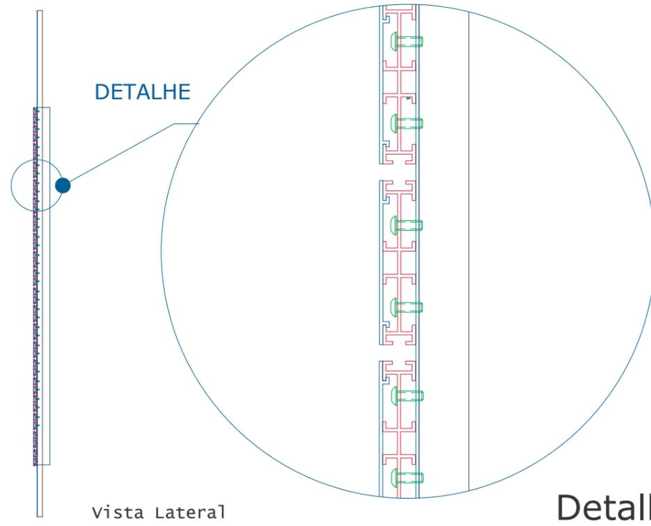
Detalhe do perfil com letreiro deslizante. s/ esc.
