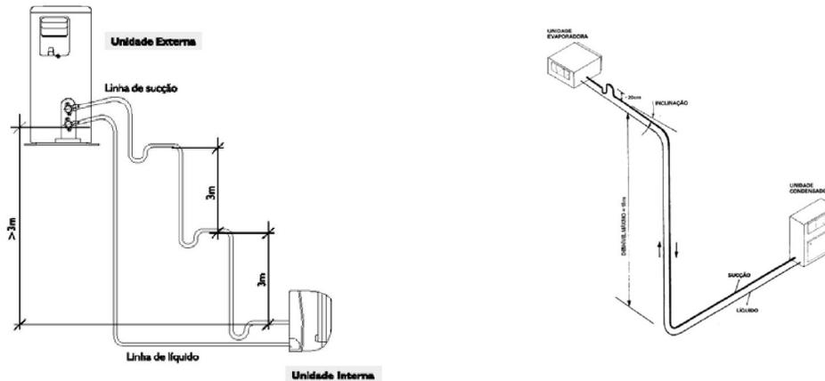
j) todas as dobras na tubulação de cobre deverão ser feitas com o auxílio de ferramenta adequada (mola de dobramento), para evitar estrangulamento dos tubos. Em hipótese alguma poderão ser feitas curvas nos tubos com as mãos;
