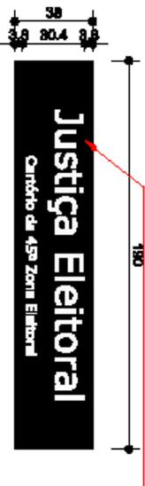
Placa em alumínio anodizado (AA10), na cor prata, fixada, com 30mm de espessura 180 x 100 cm. Letra padrão, na cor branca. Grade colorida, executada em aço inoxidável, gravada por hidrografia computadorizada. Letra padrão, na cor branca. Fixação Utilizada: Parafuso 2,5 cm x 5,0 cm. Fixada no período em observância com o nº 314 do pleito ou pleiteio, no tocante ao sistema eleitoral no Cartório Eleitoral.
